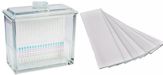
Şekil 11.1 TLC uygulama tankı ve plakalar
