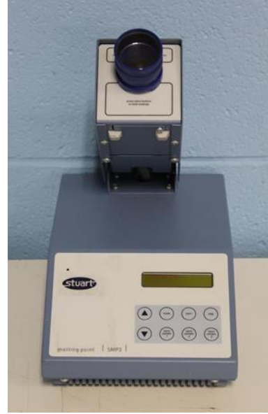
Şekil 5.1 Erime Noktası Tayin Düzenegi
