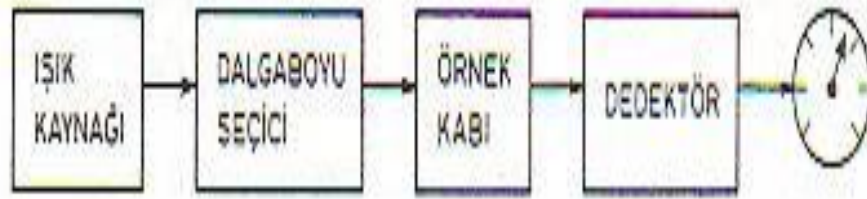
Şekil 4.2 Genel spektrofotometre düzeneği
